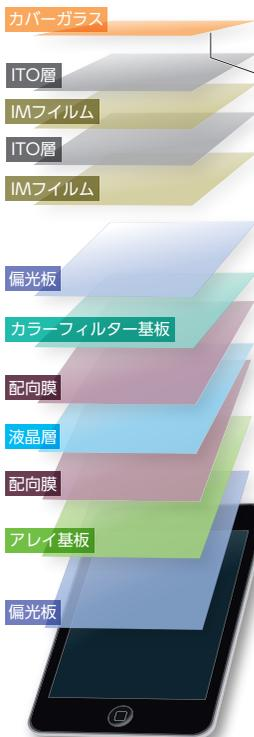
指先が触れた時に電極の変化をX軸・Y軸の電極列から知ることによって位置を把握できます。
