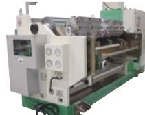
多段化したスロットル構造により単層～多層の同時塗工を実現。
