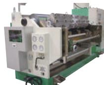
多段化したスロットル構造により単層～多層の同時塗工を実現。
