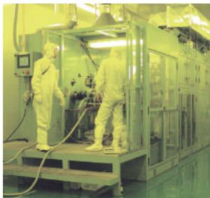
液晶用表示装置に代表される光学用途フィルム塗工装置及び関連する乾燥・熱処理装置。
