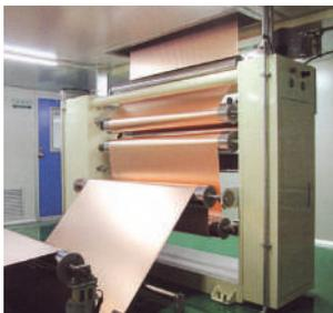
半導体、FPC等電子部品関連用塗工装置及び関連する乾燥・熱処理装置。
