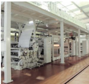
一般産業資材用のフィルム用塗工装置及び関連する乾燥熱処理装置。
