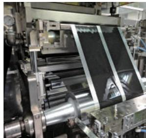
二次電池用塗工装置及び関連する乾燥・熱処理装置。塗工機以外の二次電池用製造装置及び関連機器。
