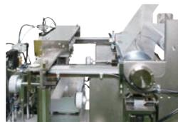
WET10 $\mu$ m以下の薄膜塗工。複雑な任意パターン塗工。
