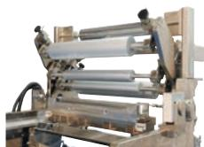
優れた薄膜塗工性能。スジムラがない。容易なロッド交換方式。
