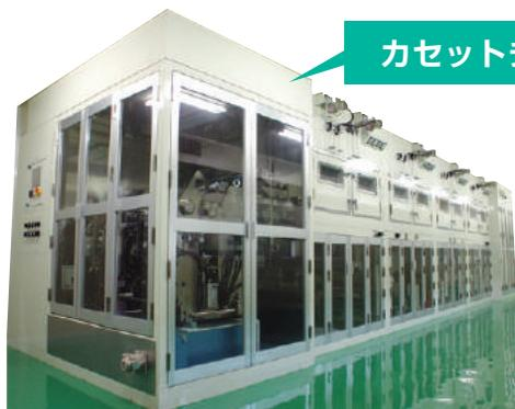
カセットチェンジ方式で容易に塗工方式の変更が可能
